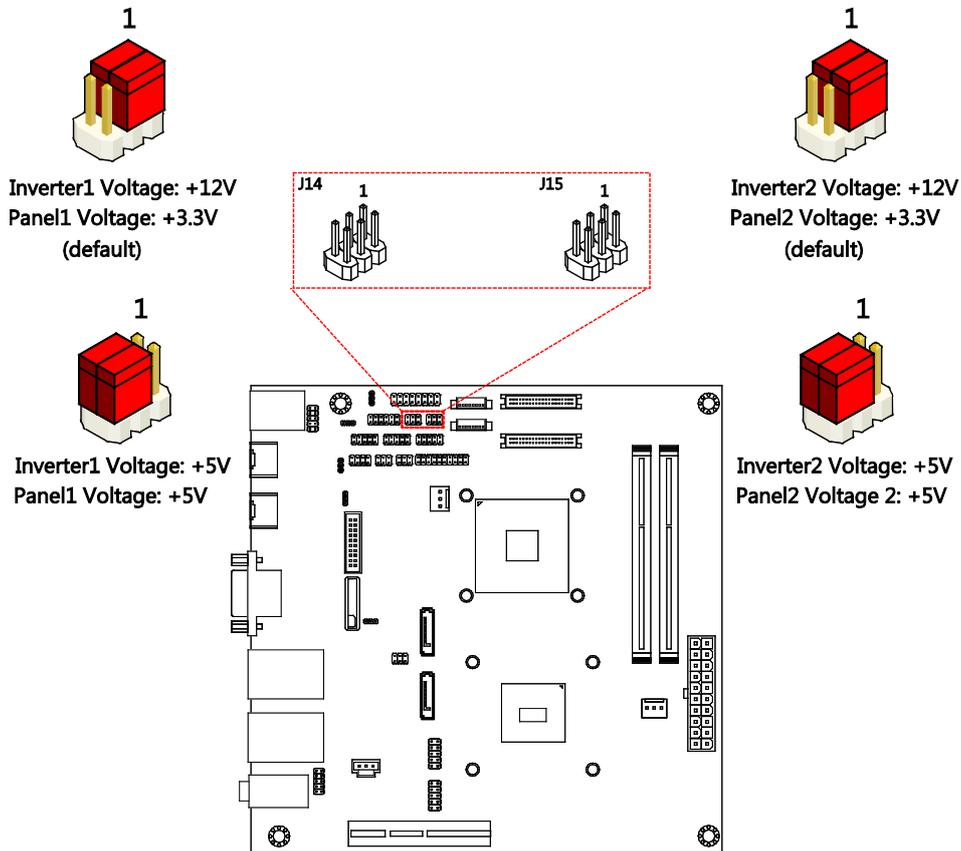
Figure 40: LVDS1 and LVDS2 power jumper diagrams
