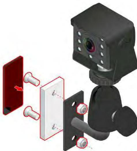
图 17：驾驶员摄像头支架安装磁铁示意图
