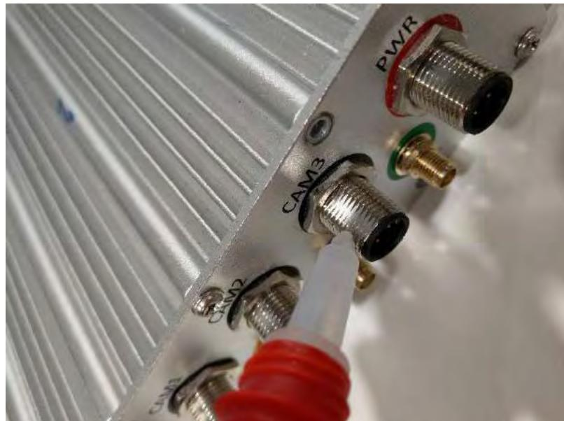
图 20: 在接环处上螺丝胶示意图
