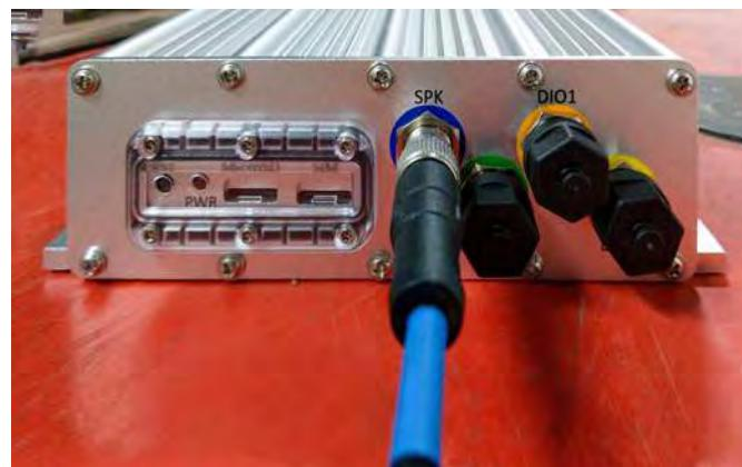
图 21: 喇叭接线安装示意图
