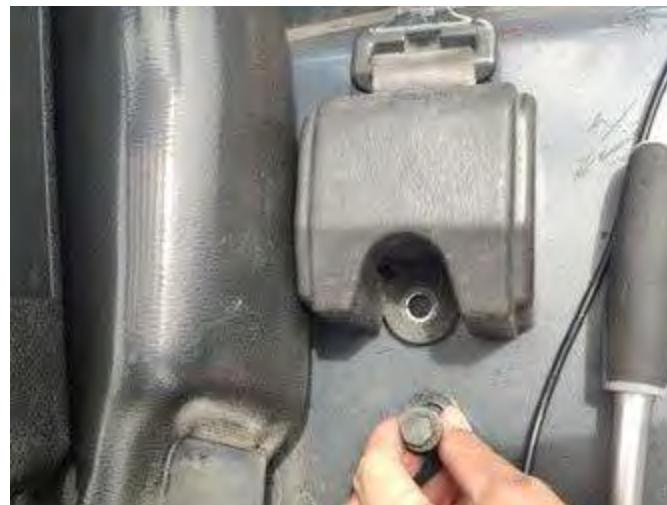
图 80: 移除原厂安全带插扣示意图
