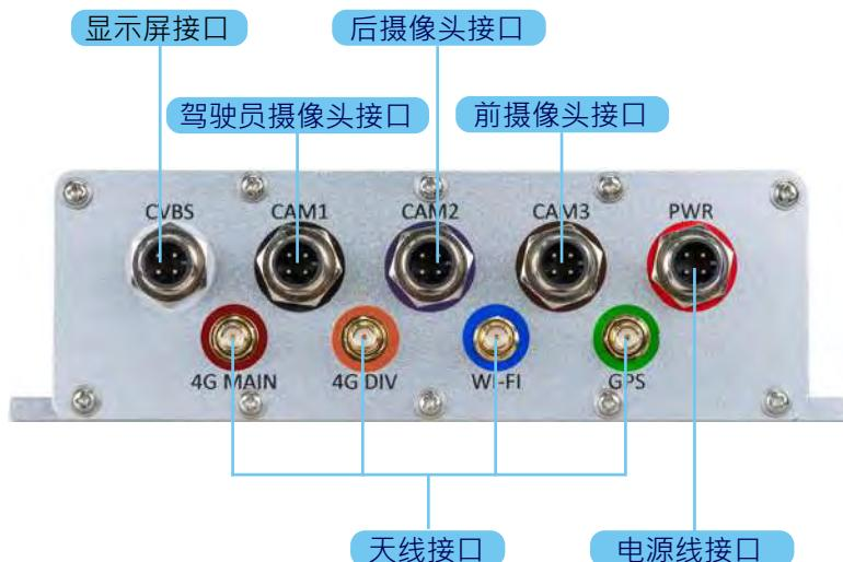
图 02：后方面板 I/O 排列示意图
