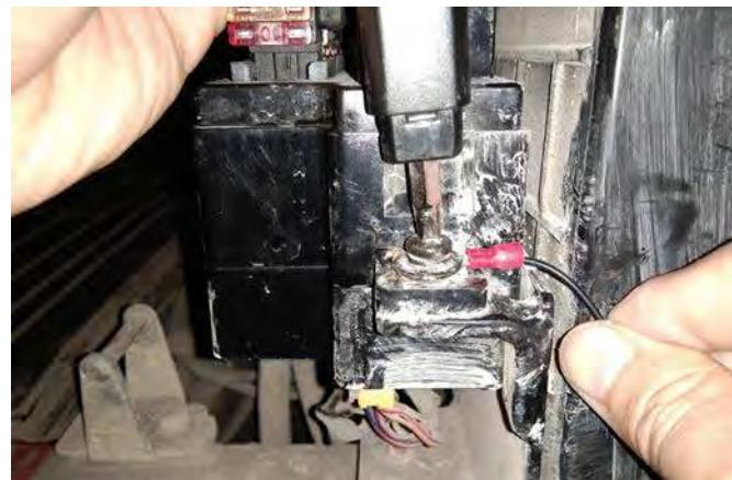
图 29: 地线安装示意图
