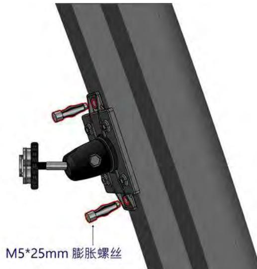
图 73: 透过膨胀螺丝安装支架示意图
