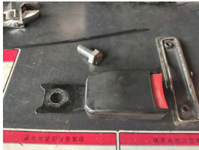
图 79: 移除原厂安全带插头示意图
