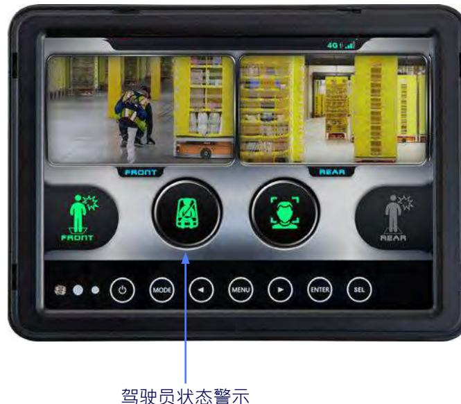
图 83: 安全带UI示意图
