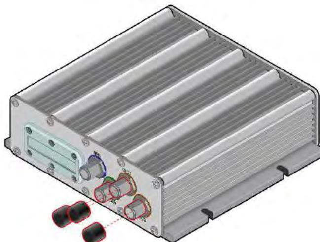
图 06：主机前方安装防尘盖示意图
