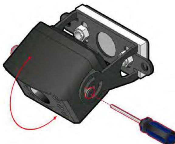
图 38: 调整摄像头角度锁紧螺丝示意图
