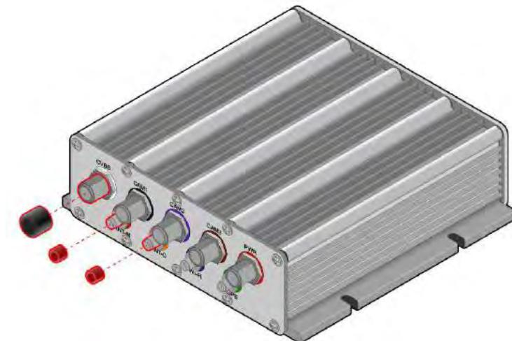
图 07: 主机后方安装防尘盖示意图
