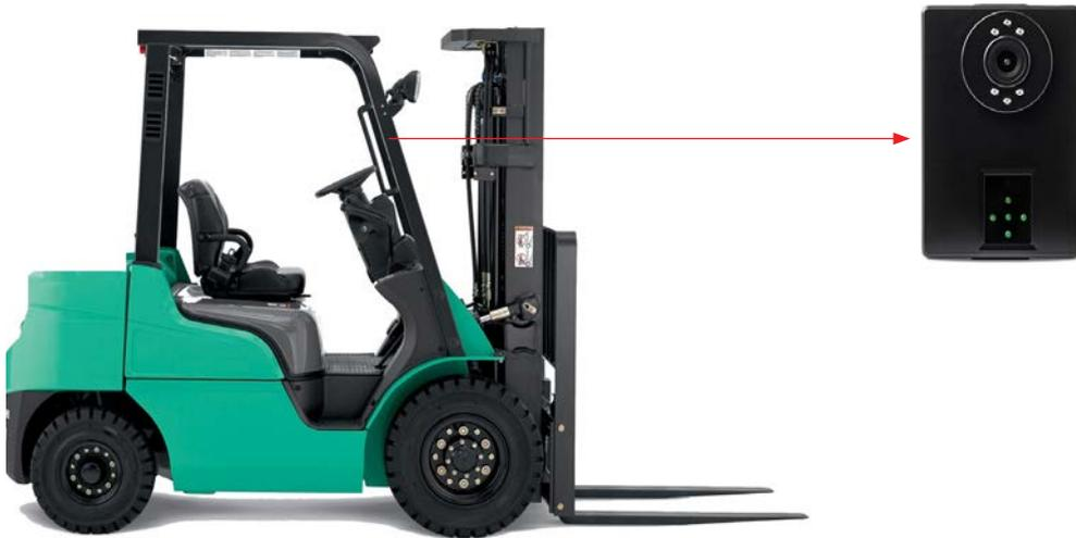
图 03: 摄像头安装位置示意图
