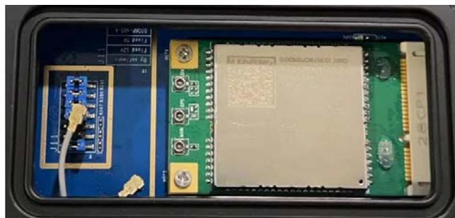
图 56: 保护 4G LTE miniPCIe 模块
