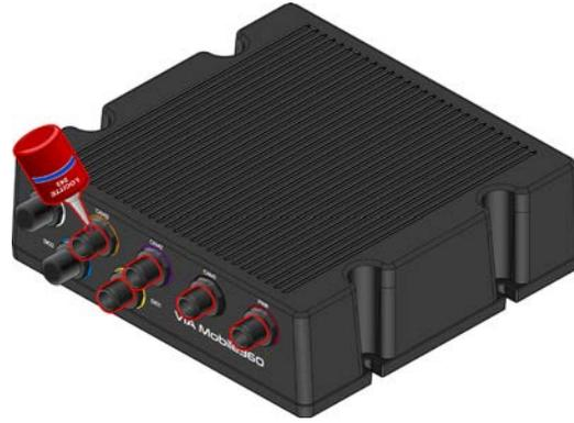
图 28: 电缆接口涂抹螺丝胶（汉高乐泰 243）示意图
