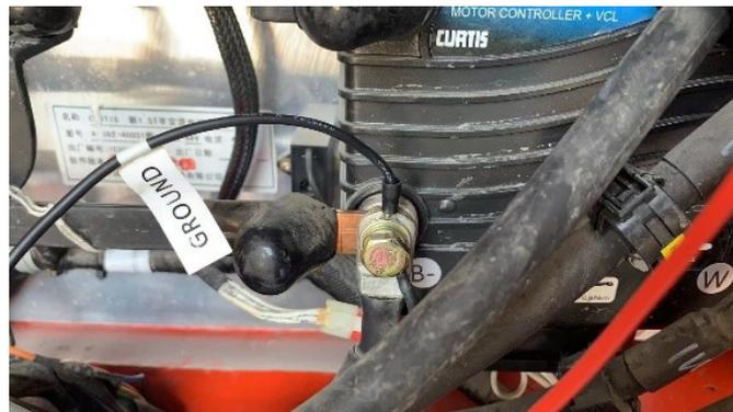
5. 松开步骤 4 找到的回路上的螺栓，将 威盛 Mobile360 直流电源模块上黄色电缆末端的 Y 型接头置于螺栓下方，拧紧螺栓以固定电缆。
