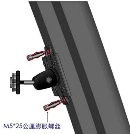
图 44: 7 寸 CVBS 显示屏支架钻孔安装示意图
