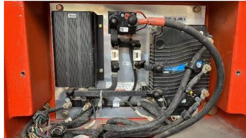
3. 确认电池正负电极与 ACC/IGN 回路在叉车上的位置之后，关闭叉车电源，并测量电池正电极提供的电压符合叉车技术规格而且落在电源模块能正常工作的区间（36V~100V DC）。接着确认步骤 2 找到的 ACC/IGN 回路在叉车电源关闭的时候并没有供电。启动叉车之后，再测量一次确认 ACC/IGN 回路提供的电压符合叉车规格及落在正常工作的区间（36V~100V DC）。
