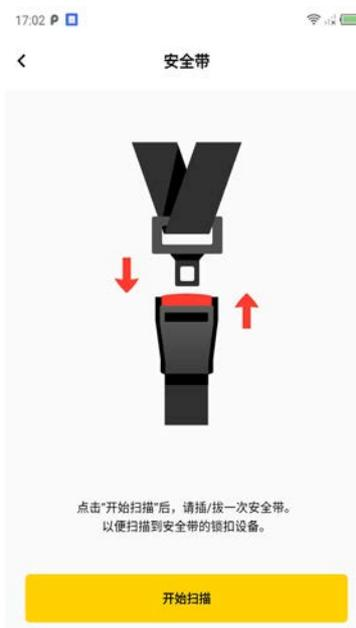
7. 威盛 Mobile360 叉车安全监控系统会收寻附近可用的安全带传感器，安全带传感器需要做一次插拔的动作启动搜寻功能。
